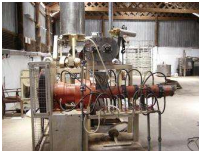
Figure 4. L'équipement d'extrusion: Sigma Feeds Nairobi Kenya, qui produit les aliments flottants pour poissons pour l'industrie aquacole au Kenya. Cet équipement ouvre la possibilité d'élevage de poissons en cage, qui exige un aliment flottant.
